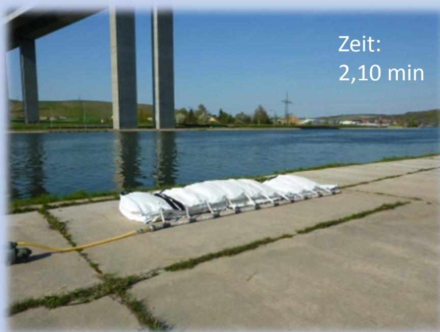
HWS-System mit Luft füllen
